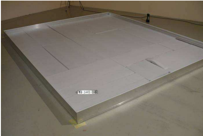
Figure 1: Construction avec profil et matériau absorbant
